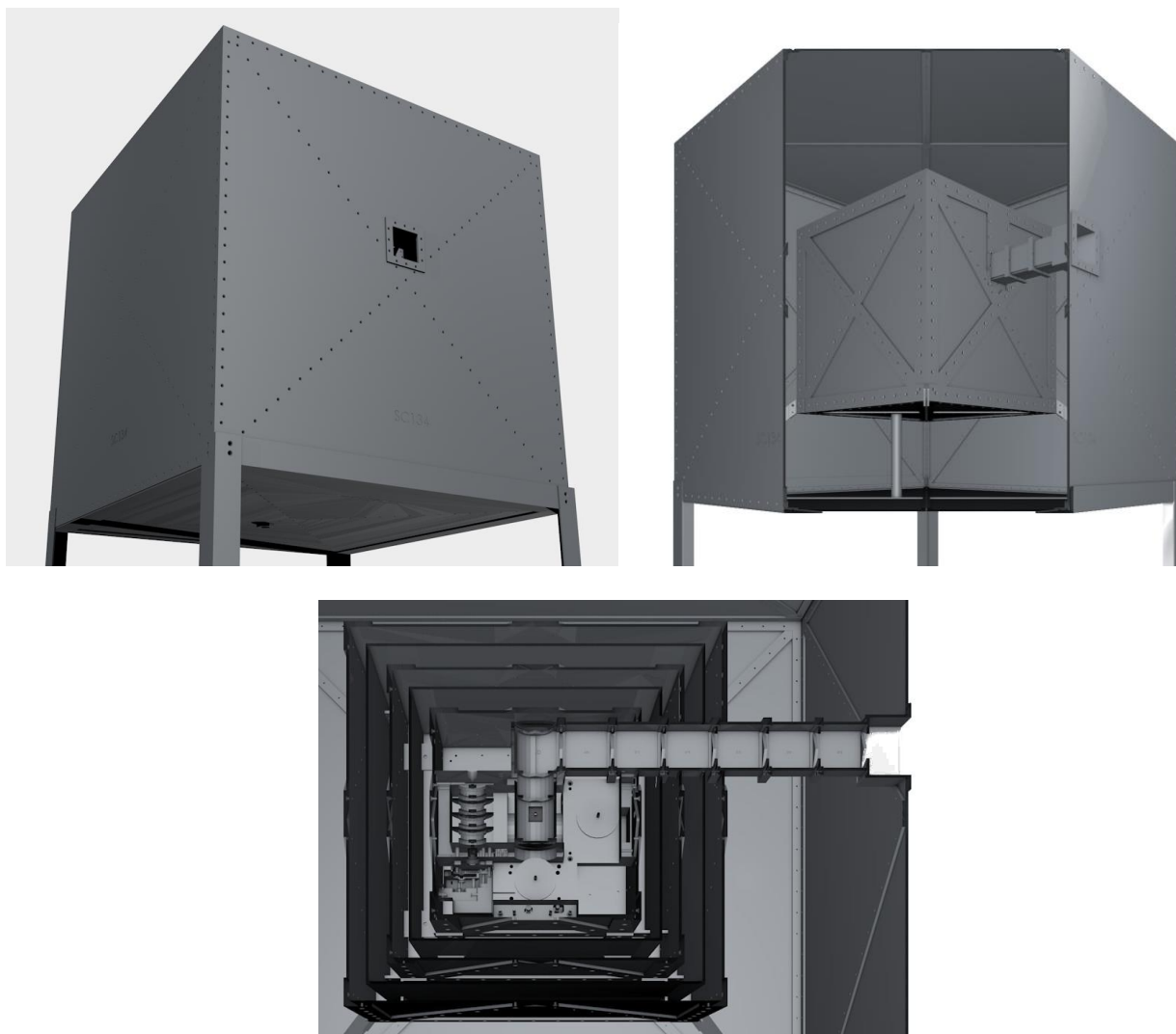
Figura 2: Alcune immagini della “macchina”; 1) vista esterna, 2) vista interna tagliata su uno spigolo, 3) sezione verticale in corrispondenza della zona centrale
